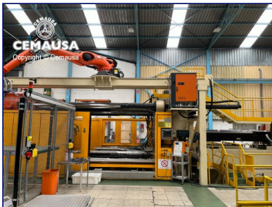
Inyectora termoplástico 2700 ton. con robot
