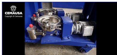
Dosificador volumétrico doble máx 120 kgs/hora.
